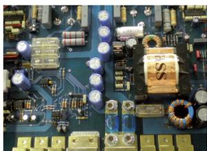
Particolare delle connessioni d' uscita degli altoparlanti con accettazione di cavi fino a 8 mmq. Nella parte centrale sono visibili le connessioni di alimentazione a 12 Volt e il trasformatore switching realizzato in filo Litz.
